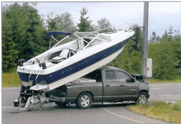
Die Sicherungskräfte für Ladegüter sind in Richtlinien festgelegt (siehe VDI 2700 ff.). Danach muss die Ladung in Fahrtrichtung, zur Seite und nach hinten bestimmten Massenkräften standhalten. **Auch Boote müssen während des Transportes auf dem Bootsanhänger/Trailer ausreichend gesichert sein.**
